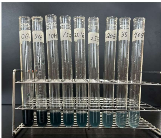
図5 0.010mol/L のクロム(Ⅲ)の吸着効果
