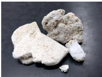
図1 江田島海岸に漂着した牡蠣いかだの浮力体の一部(プラスチック)
