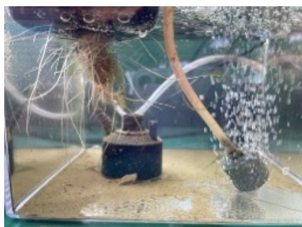
図8 超音波で変色沈下したアオコ
