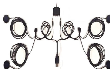
図 3 低周波が発芽に与える影響と使用した伝振動スピーカー
