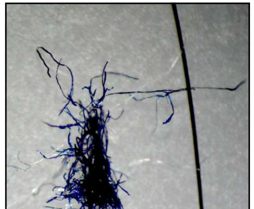
図2 マイクロファイバーの実体顕微鏡写真（右の黒い線はヒトの髪の毛）
