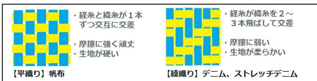
図5 平織りと綾織りの模式図と特徴（青色が経糸、黄色が緯糸を表す）
