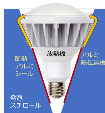
図10 LED（左：熱伝達板 中：LEDカバー 右：カバー断面図）
