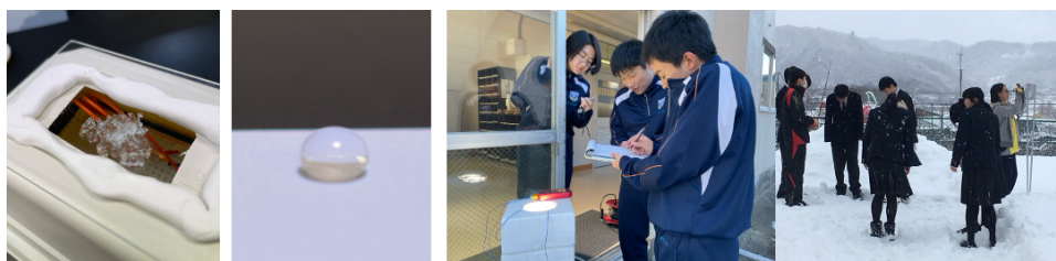
図 11 融雪（左のアクリルは溶けないが右のロータスは LED 熱で水を弾く）
