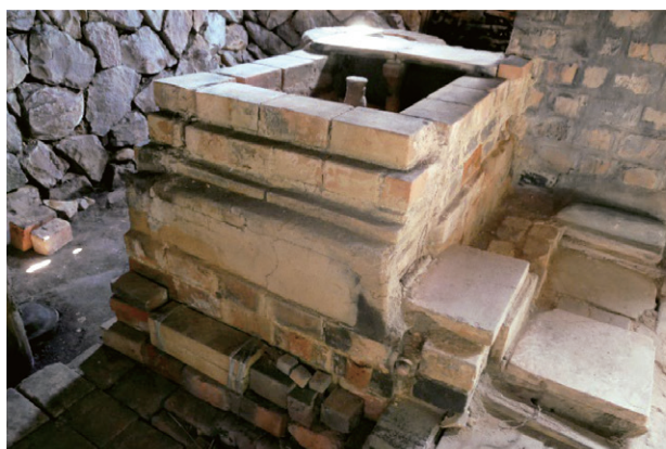
写真3 上絵窯 (左 正面、右 焼成室内部)
