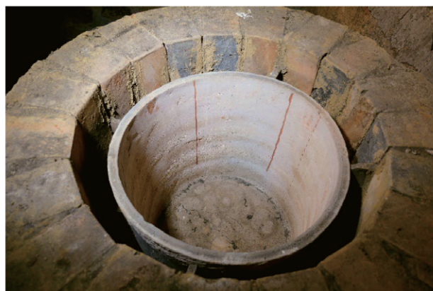
写真4 楽焼窯 (左 正面 (焚口)、右 焼成室内部 (内窯))
