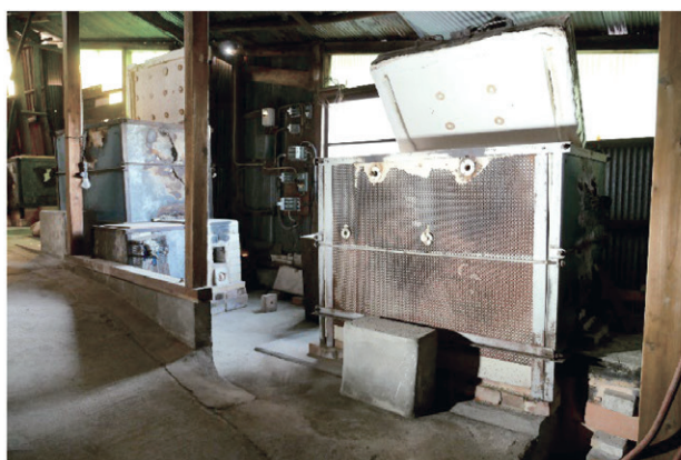
写真6 電気窯（左 右から1～4号窯、右 2号窯とその還元焼成用焚口）
