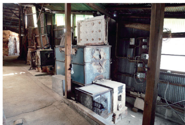
写真6 電気窯（左 右から1～4号窯、右 2号窯とその還元焼成用焚口）
