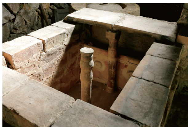
写真3 上絵窯 (左 正面、右 焼成室内部)
