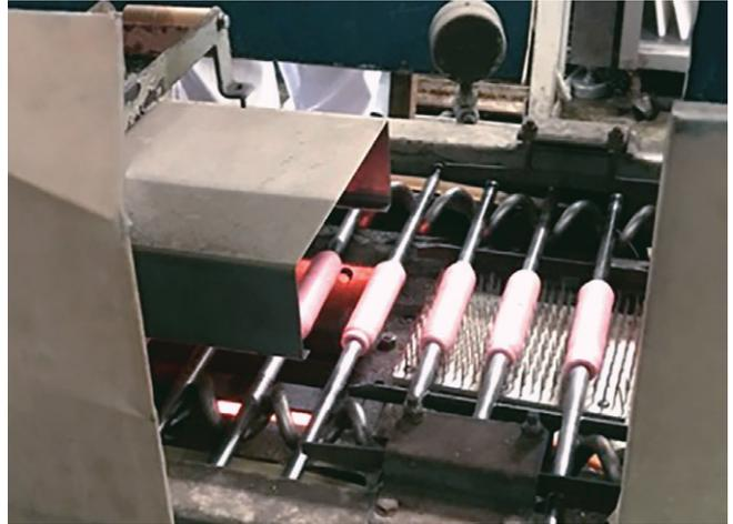
図5 A社でのえびちくわの焼成工程
